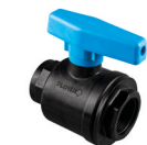
VALVOLA A SFERA FF in PP PN10, Guarnizioni EPDM e PTFE. Sfera in ABS
